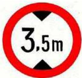
Dieses Zeichen zeigt an, dass das Fahren mit Fahrzeugen, deren größte Höhe die im Zeichen angegebene Höhe überschreitet, verboten ist. Es kann oberhalb der Fahrbahn entsprechend der vorhandenen Höhe angebracht werden.
