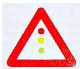
Dieses Zeichen kündigt eine Lichtsignalanlage an. Es ist nur dann anzubringen, wenn mit einer Lichtsignalanlage üblicherweise nicht gerechnet werden muss oder wenn eine solche Anlage schlecht wahrnehmbar ist.
