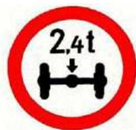
Dieses Zeichen zeigt an, dass das Fahren mit Fahrzeugen, deren Achslast die im Zeichen angegebene Achslast überschreitet, verboten ist.
