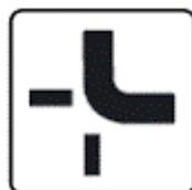
Eine solche Zusatztafel unter den Zeichen „Vorrang geben“, „Halt“ oder „Vorrangstraße“ zeigt an, dass eine Straße mit Vorrang einen besonderen Verlauf nimmt (§ 19 Abs. 4).
